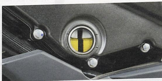
**Ölstand checken!** So muss das aussehen: Ölstand knapp unter Maximalwert. So hell und klar ist das Öl allerdings nur direkt nach dem Einfüllen.
